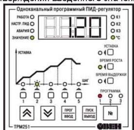
19 Для задания времени в течении которого прибор будет поддерживать температуру на уровне, заданном уставкой (см. пп. 14 и 15) нажмите кнопку . При этом светодиод «ВРЕМЯ РОСТА» погаснет, а светодиод «ВРЕМЯ ВЫДЕРЖКИ» загорится. На цифровом индикаторе отобразится текущее значение времени выдержки на первом шаге.
