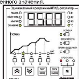
16 Для задания времени выхода на уставку на втором шаге нажмите кнопку **ВРЕМЯ РОСТА**, при этом светодиод «УСТАВКА» погаснет, загорится светодиод «ВРЕМЯ РОСТА». На цифровом индикаторе отобразится значение текущей уставки времени за которое прибор выйдет на заданную температуру при регулировании.
