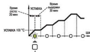
13 Нажмите на кнопку **УСТАВКА**, при этом загорится светодиод «УСТАВКА», а на цифровом индикаторе отобразится текущее значение уставки регулирования на втором шаге.
